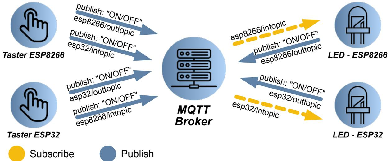
Bild 4.1.3: MQTT Test Aufbau Konzept der Topics
