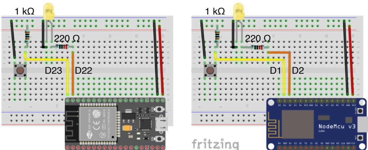
Bild 4.1.2: MQTT Test Aufbau mit 2 Boards
