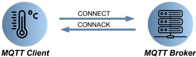
Bild 4.1.7: MQTT Connect Packet
