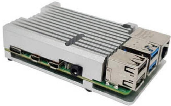
Ein Raspberry Pi 4 ist grundsätzlich leistungsstark genug für SDR-Anwendungen, insbesondere wenn er mit Software wie GQRX oder SDR# verwendet wird. Die verschiedenen Modelle des Raspberry Pi 4, besonders die Varianten mit 4GB oder 8GB RAM, bieten ausreichend Ressourcen zur Verarbeitung von Funksignalen in Echtzeit und können eine Vielzahl von SDR-Programmen unterstützen , .
